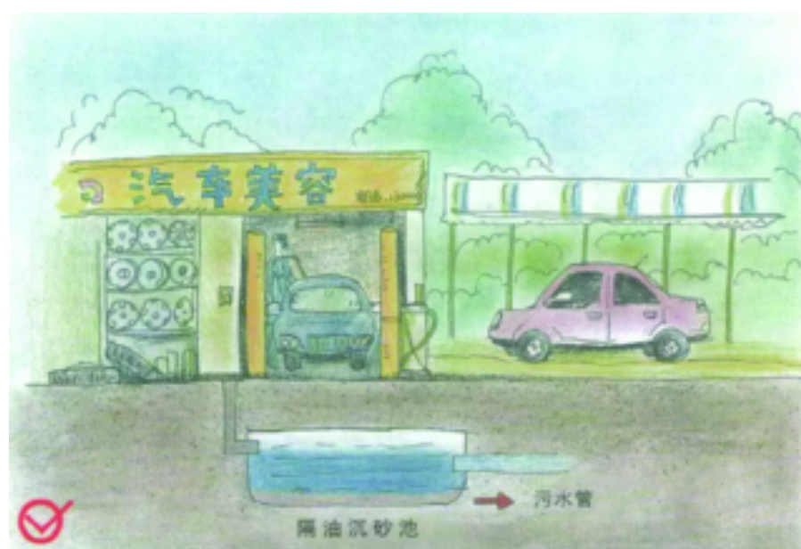
√汽车维修、洗车排放的污水经隔油沉砂池处理后排入市政污水管道
